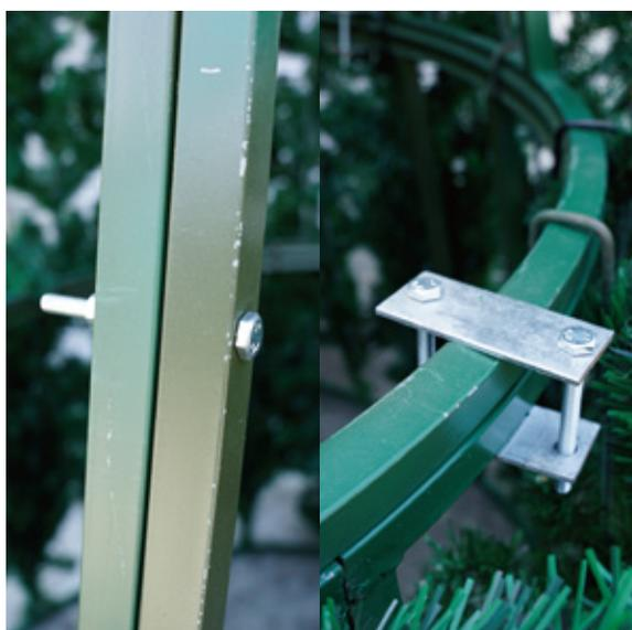
③付属のボルトと金具を使い、フレームを接続して組み立てていきます。
